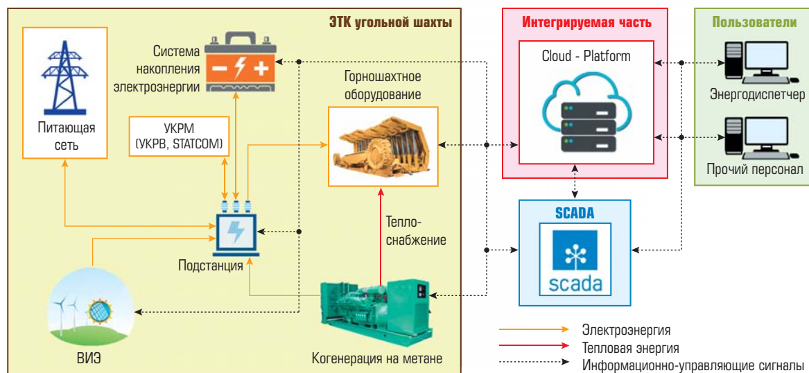
Рис. 1. Структурная схема угодобывающего предприятия с интеграцией распределенных энергоресурсов
